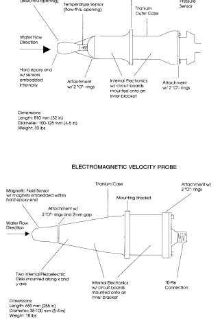
CONDUCTIVITY TEMPERATURE DEPTH PROBE
